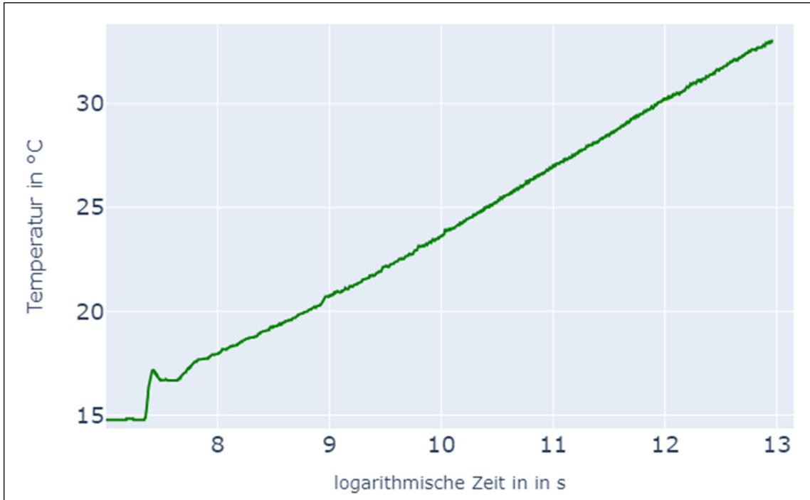
Abb. B-Anh.8 Halblogarithmische Darstellung Mitteltemperaturverlauf, TRT vom 17.03.2020.
